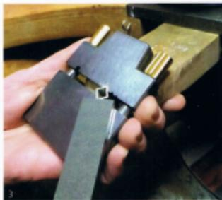
Klein, schwer und enorm zeitparend: Die Profilspannlehre (1), auch Scharnierkaliber genannt, kommt beim Absägen und Planfeilen von Metallprofilen und Blechen sowie beim Schneiden und Feilen von Scharnieren im 45- und 90-Grad-Winkel zum Einsatz. Dazu wird das Rohr zwischen zwei Elementen fest eingepannt (2) und anschließend mit einer Feile begradigt (3).
